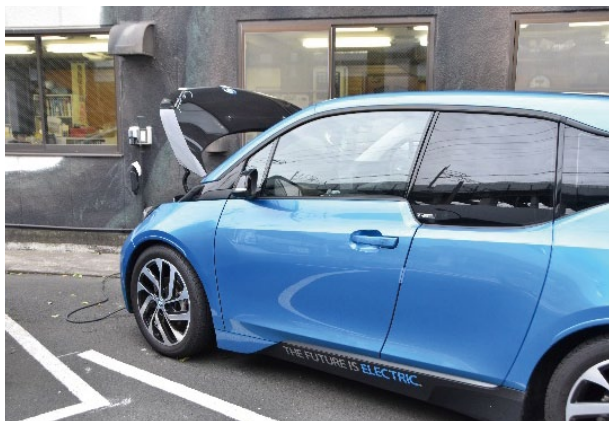
屋外充電ポートでの充電 ～コードの長さは7m～
