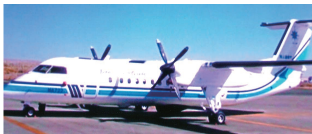
海上保安庁航空機、羽田航空基地所属のMA722。長さ25.68m。幅27.43m。高さ7.49m。プロペラ機。ボンバルディアDHC8型
