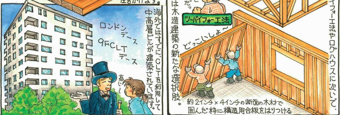
**早い!** 工場で作ったCLTパネルを現場で組立てるだけ。工期短縮。
