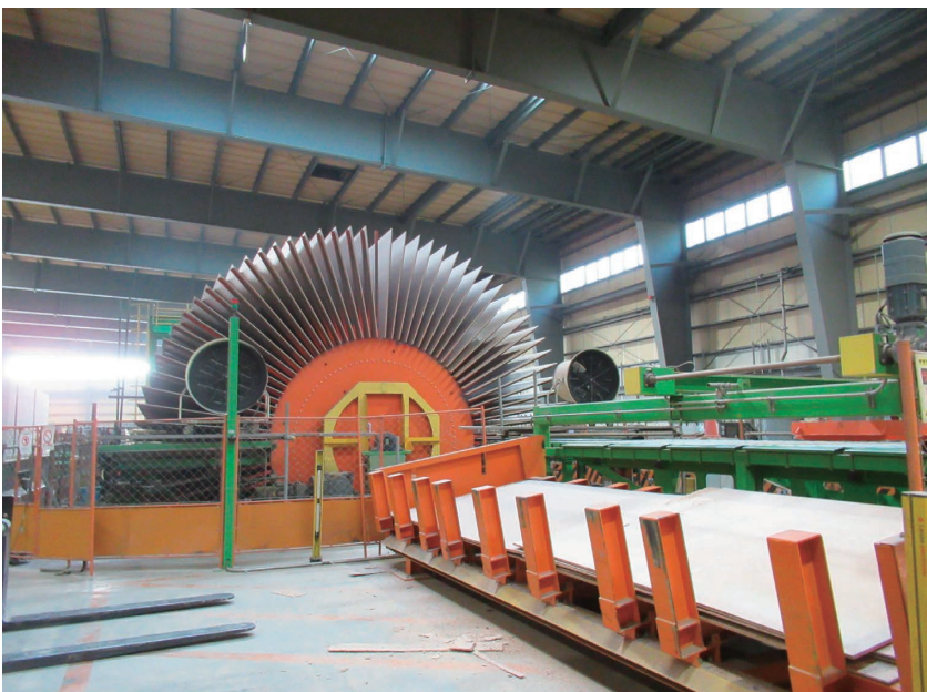
ストレージ・トラパーサー、冷却して一枚一枚を乾燥させます
