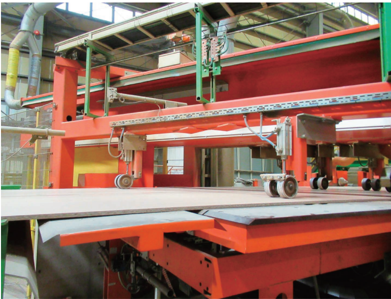
フライングソー、連続プレスされたパーチを刃が斜めに移動しカット（不思議です）
