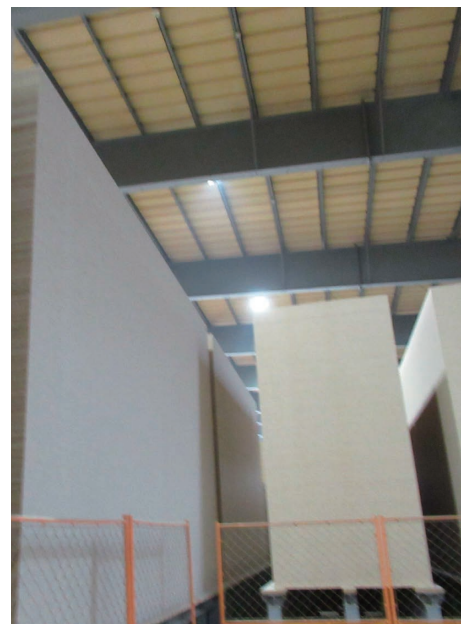
ストレージ・トラパーサー、冷却して一枚一枚を乾燥させます
